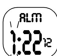
Oprima repetidamente el botón **MODE** hasta que aparezca la abreviatura RLM [ALARMA] y la hora fijada de la alarma. Despues mantenga apretado el botón **SET/LIGHT/STP/RST.** durante 3 segundos aproximadamente. En seguida destella el dígito de la hora.
